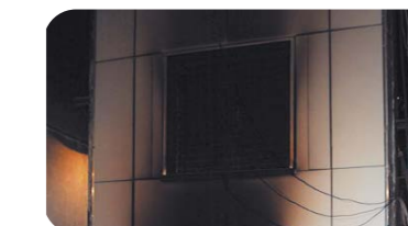
Огневые натурные испытания конструкции НВФ с применением алюминиевых композитных панелей BILDEX по ГОСТ 31251
